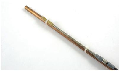
1) Positionner le capteur sur le tube, enrouler les colliers de serrage et les fermer aux deux extrémités;
