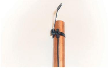
1) Enrouler le collier au tube et le fermer;
