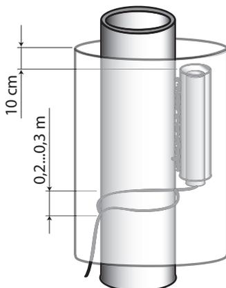
Réaliser une bonne isolation thermique du couplage.
