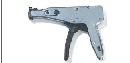
2) ur la pince à collier de serrage équipée d'un dynamomètre (référence CM00000006) régler la force de serrage 250N (position 6 de l'index de la pince);
